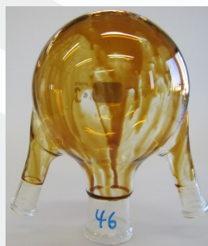
Масло 10W-40 не прошло тест Daimler Oxidation Test
